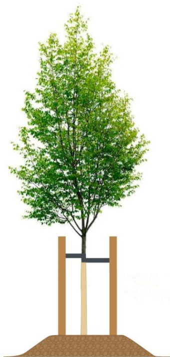
Obr. č. 2 Způsob kotvení výsadeb – višně a duby v liniích
